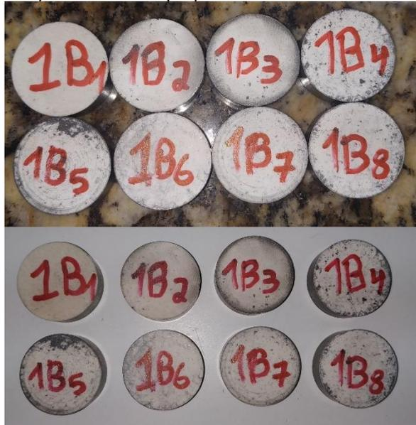
Figura A3 - Antes e depois dos bates propelentes sinterizados a 125 °C por 1,5 horas
