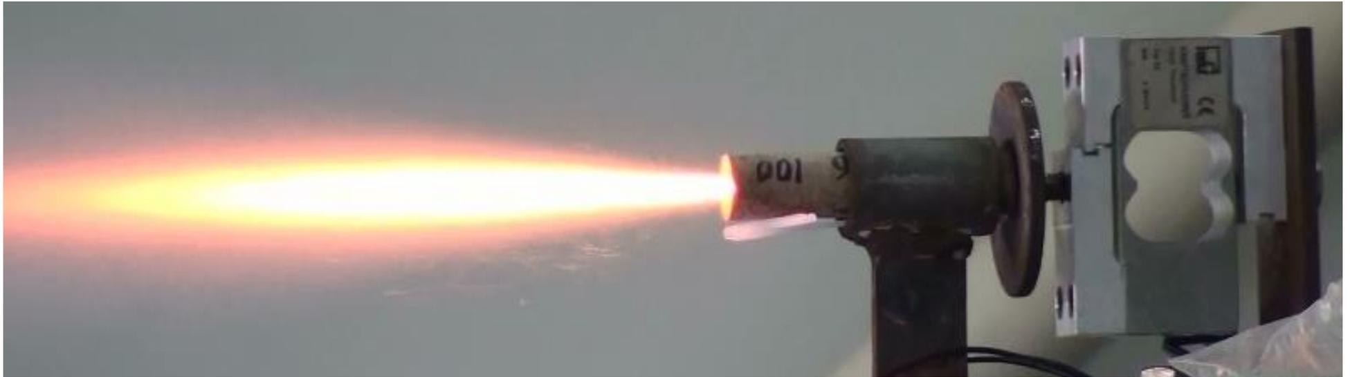
**Motor-foguete Bandeirante classe C em funcionamento durante a aquisição de dados de sua curva de empuxo em banco estático.**
