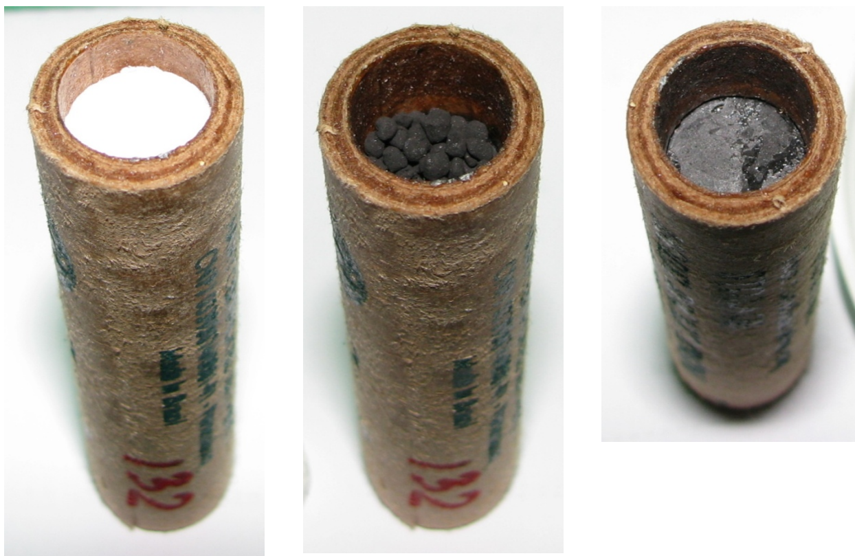
Figura 4. Fotos mostrando a tampa de fechamento, a carga ejetora e a carga temporizadora de motores-foguete Bandeirante do tipo C6-5.
