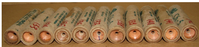
Figura 3. Foto mostrando as tubeiras de motores-foguete Bandeirante do tipo C6-5.
