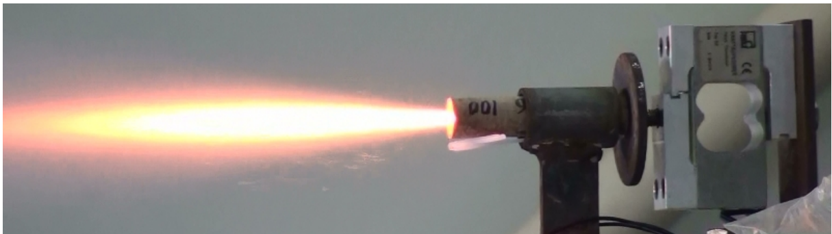
Figura 12. Foto mostrando um motor-foguete Bandeirante do tipo C6-0 em funcionamento durante a aquisição de dados de sua curva de empuxo em banco estático.
