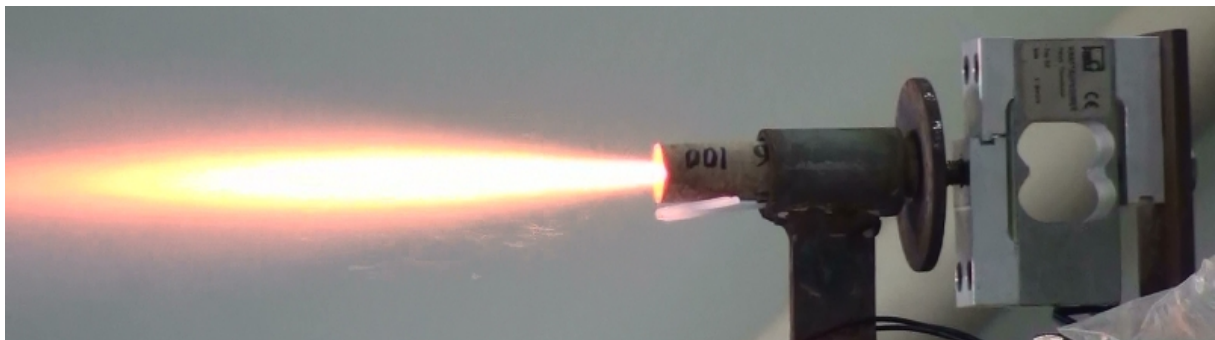
Figura 12. Um motor-foguete Bandeirante do tipo C6-0 em funcionamento durante a aquisição de dados de sua curva de empuxo em banco estático.
