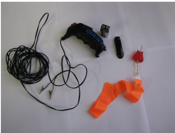
Figura 2. Sistema de ignição do tipo Quest e ignitor do tipo Bandeirante.
