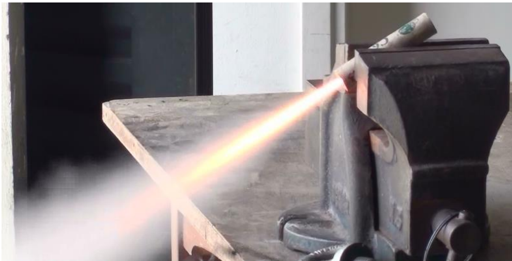
Figura 5. Foto mostrando um motor Bandeirante C6-5 durante a queima da sua carga propulsora.
