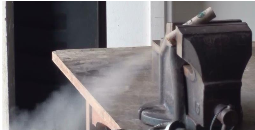
Figura 6. Foto mostrando um motor Bandeirante C6-5 durante a queima da sua carga temporizadora.
