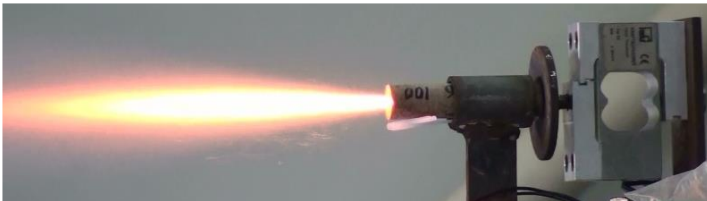
Figura 12. Um motor da Bandeirante do tipo C6-0 em funcionamento durante a aquisição de dados da sua curva de empuxo em banco estático.
