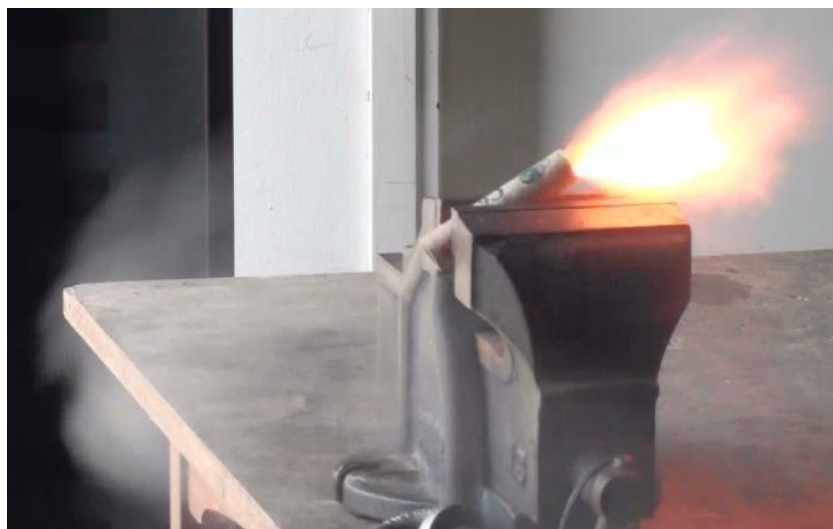
Figura 7. Foto mostrando um motor Bandeirante C6-5 durante a queima da sua carga ejetora.
