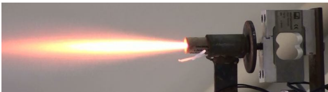
Figura 3. Foto mostrando o motor BT-90 (B6-0) durante o seu teste estático.
