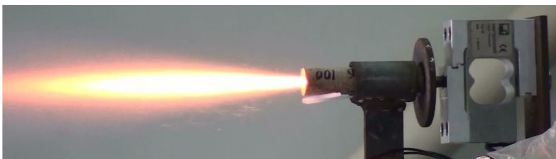
Figura 4. Foto mostrando o motor BT-100 (C6-0) durante o seu teste estático.
