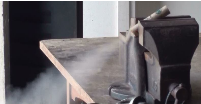
Figura 6. Foto mostrando o motor BT-123 (C6-5) durante a queima da sua carga temporizadora.
