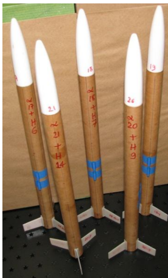
Figura 24. EMs \alpha -17 a 21 já montados e integrados com pára-quedas e altímetro.
