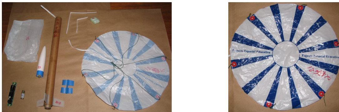
Figura 23. Componentes do EM \alpha -21 com pára-quedas e altímetro.
