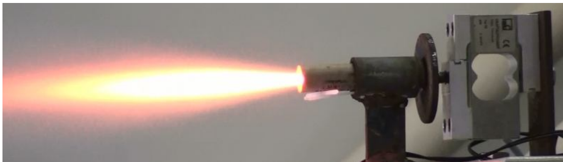
Figura 2. Foto mostrando o motor BT-80 (A6-0) durante o seu teste estático.
