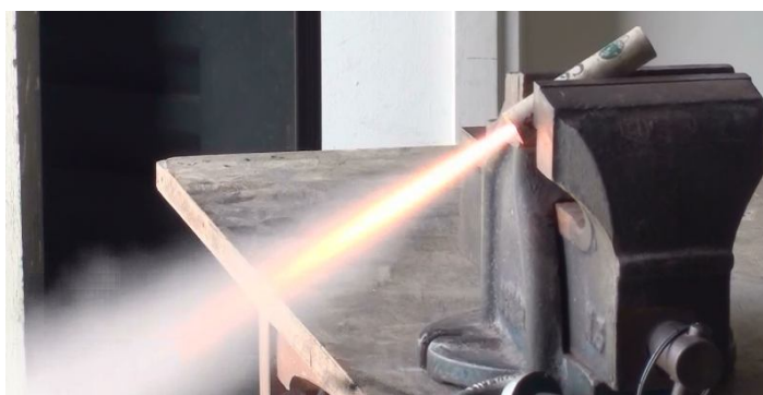
Figura 5. Foto mostrando o motor BT-123 (C6-5) durante a queima da sua carga propulsora.
