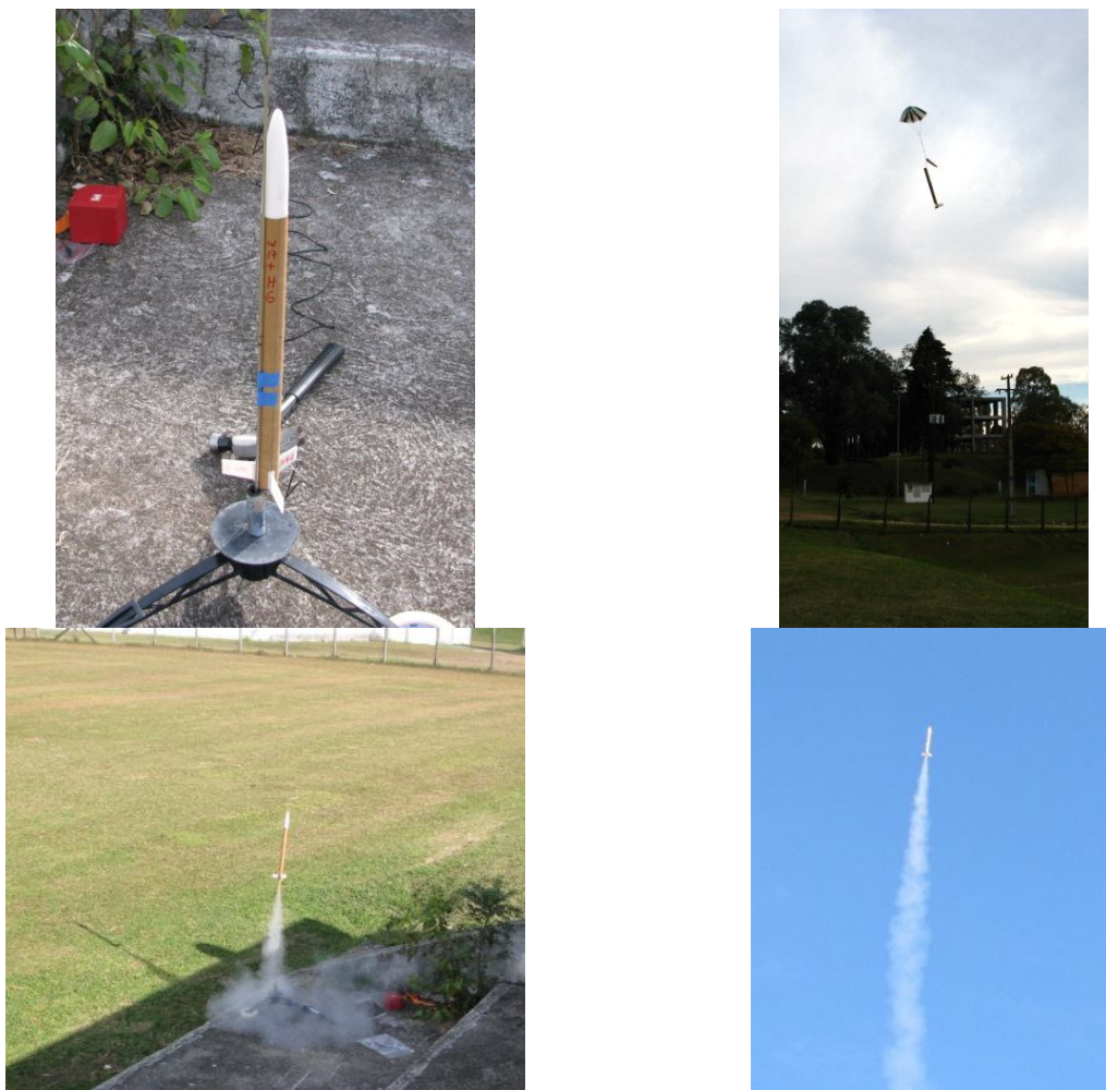
Figura 25. EM \alpha -17 na rampa, decolando, voando e caindo com seu pára-quadras.
