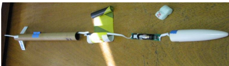
Figura 21. Componentes do EM \alpha -26 já montado, com fita e altímetro.
