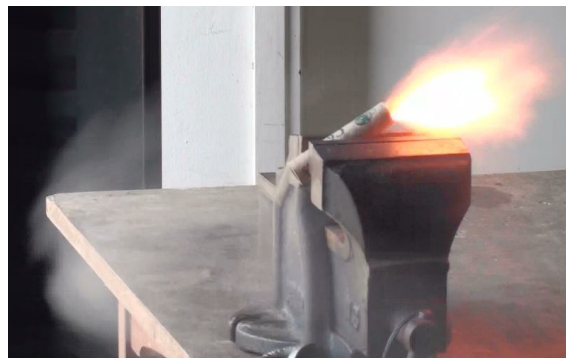
Figura 7. Foto mostrando o motor BT-123 (C6-5) durante a queima da sua carga ejetora.
