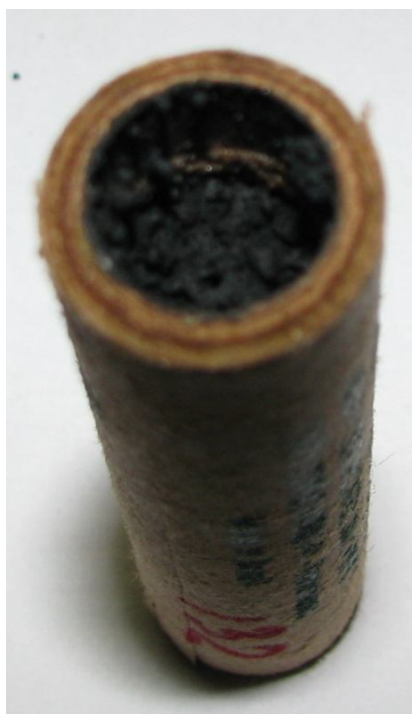
Figura 8. Foto mostrando o motor BT-132 na vertical e sua extremidade superior após seu teste estático, observando-se resíduos da combustão.
