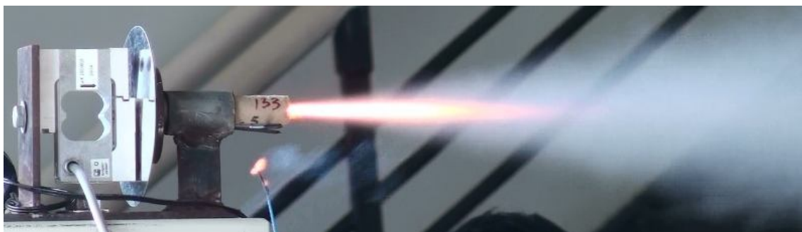
Figura 4. Foto da bancada experimental usada com os motores C6-5, mostrando a célula de carga S2-50 da HBM e o motor BT-133 durante a queima da sua carga propulsora.
