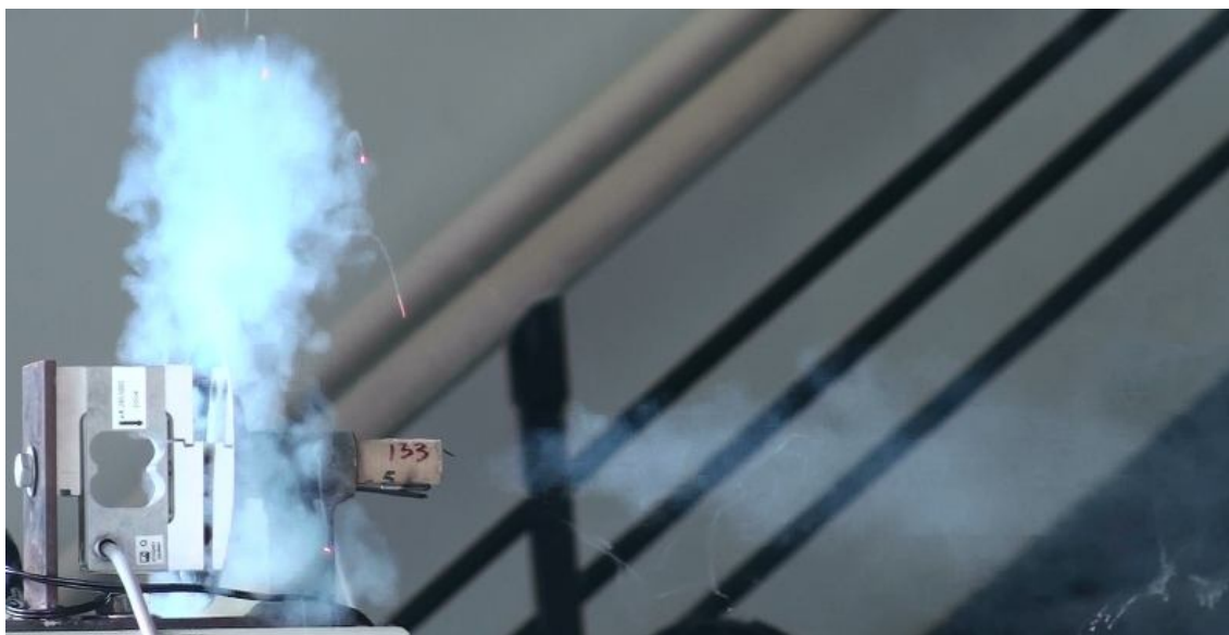
Figura 6. Foto mostrando o motor BT-133 no fim da queima da sua carga temporizadora.
