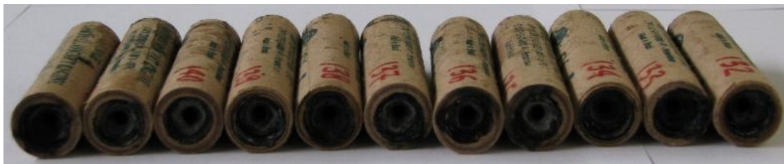
Figura 7. Foto mostrando os motores na horizontal e suas tubeiras após seus testes estáticos.
