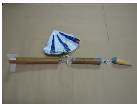
Componentes do minifoguete LAE-109: o módulo do motor e paraquedas à esquerda; o módulo (cápsula) do altímetro no centro seguido pelo próprio altímetro à direita e o nariz do minifoguete.
