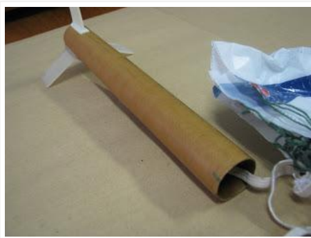
O módulo do minifoguete LAE-109 aonde ficam as empenas, motor, antichama e paraquedas.
