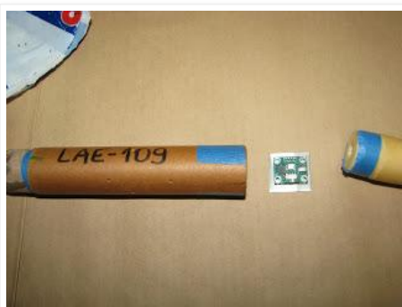
A cápsula do minifoguete LAE-109 para o seu altímetro que está à direita. Pode-se ver alguns dos orifícios na cápsula que são necessários para o funcionamento do altímetro durante o voo do minifoguete.
