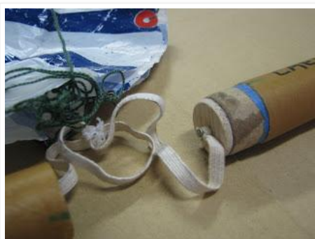
Eiástico que une o paraquedas e os dois módulos do minifoguete LAE-109. À direita pode-se ver a cápsula e o seu fechamento inferior, que protege o altímetro em seu interior dos gases da ejeção.
