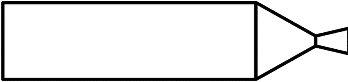
Figura 2.2 Motor-foguete representativo com expansão até um diâmetro conhecido
