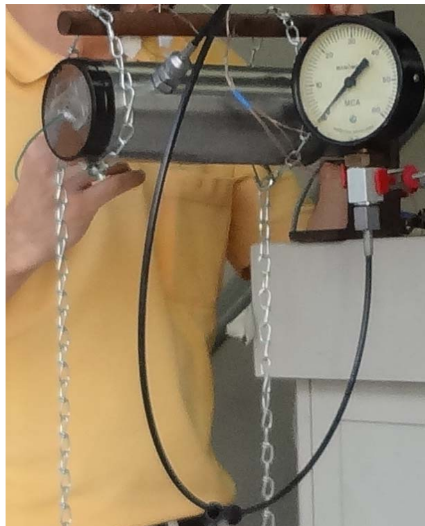
Figura 4.2 MTP-8 no banco estático com a tomada de pressão e manômetro (04/06/2015)
