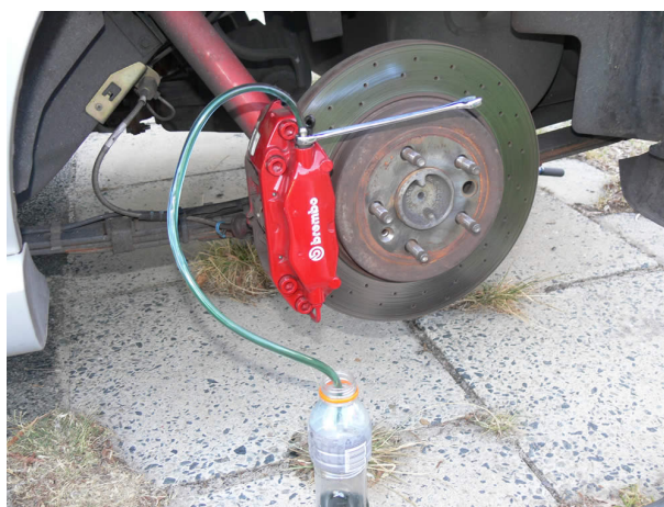
Figura B.1: Sangria por gravidade. É importante que no recipiente utilizado, tenha uma pequena quantidade de fluido de freio, o suficiente para cobrir toda a ponta da mangueira e evitar a entrada de ar..
