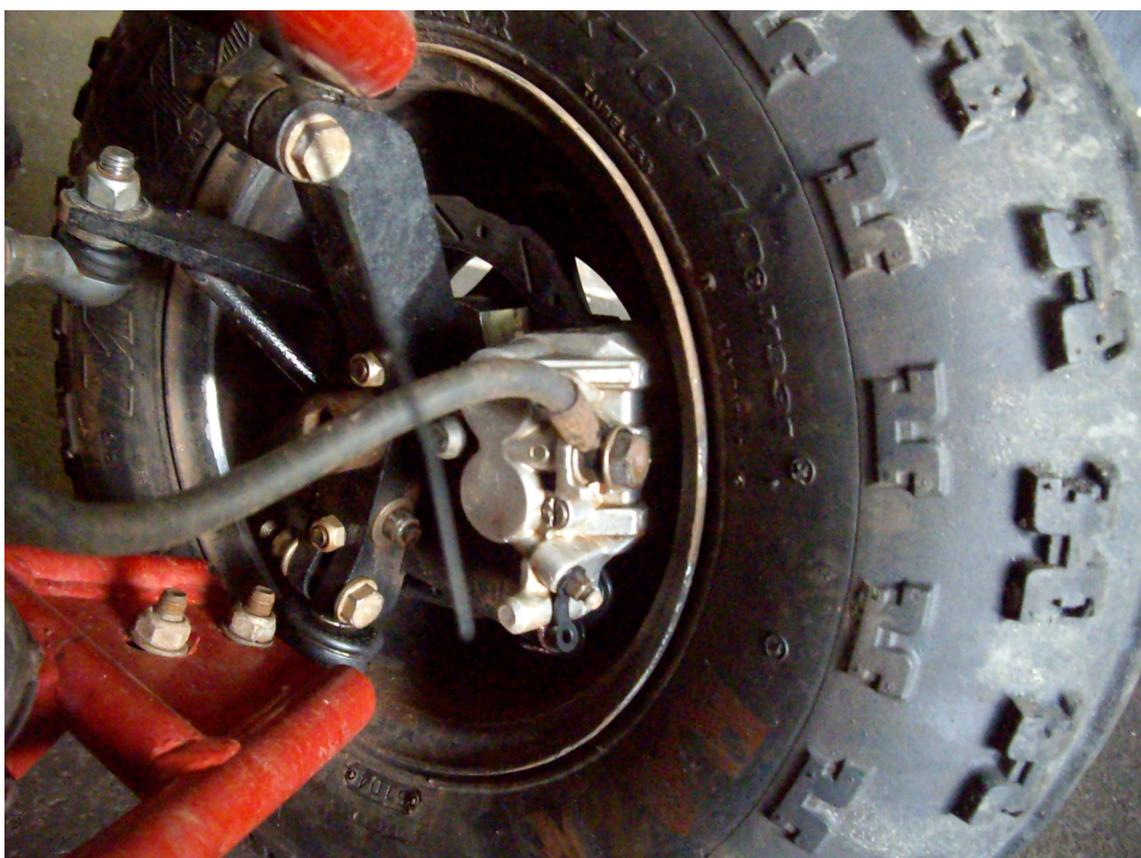
**Figura 9 - Tamanho máximo de disco de freio limitado pelo diâmetro interno da roda**
