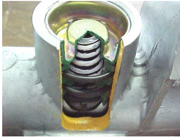
Figura 10. Mecanismo em corte na região do Yoke [7]
