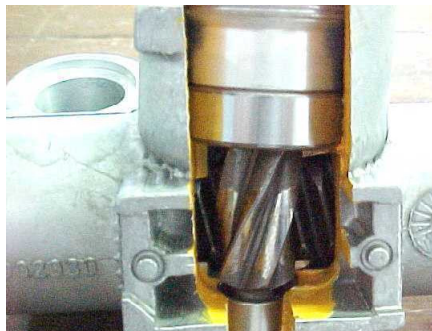
Figura 5. Mecanismo manual cortado na região de engrenamento [7]
