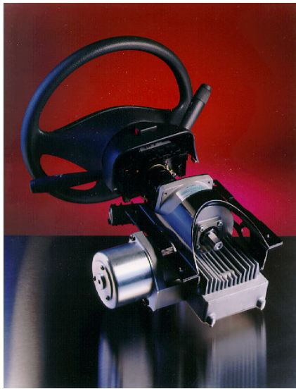
Figura 22. Sistema EPAS montado com volante [7]
