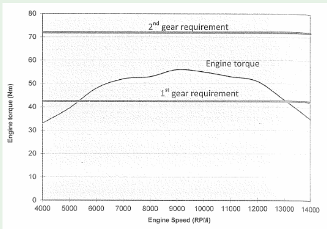
Figura: 7.4: Torques necessários na primeira e segunda marchas.
