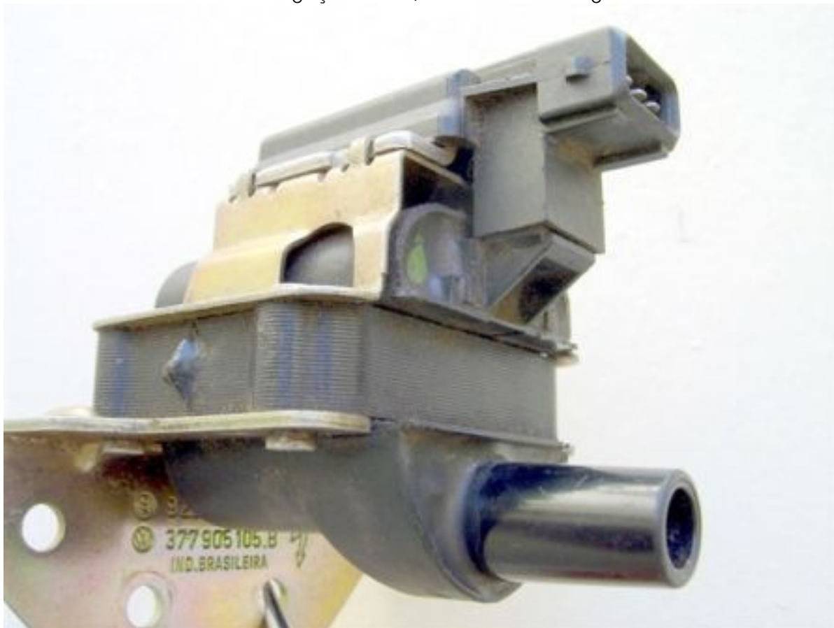
Bobina Bosch F 000 ZS0 104 (original do VW Gol 1.0 8V) com módulo de ignição integrado.
