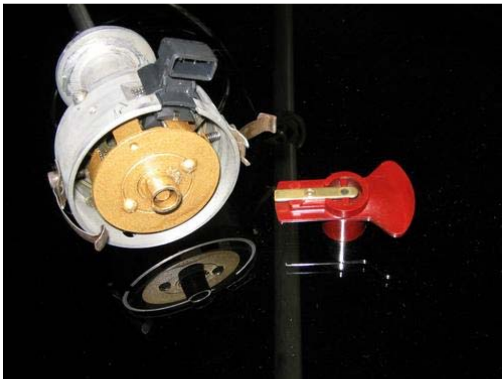
Exemplo de um distribuidor de Opala 6 cilindros com o sistema hall fixo adaptado
