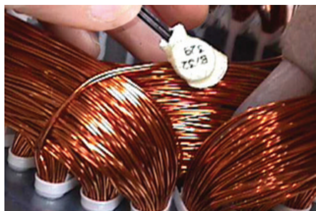
Figura 7.6 - Instalação do protetor térmico bimetálico
