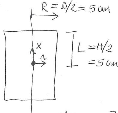
$$\frac{T(x, r, t) - T_\infty}{T_i - T_\infty} = P(x, t) \cdot C(r, t) \quad [10] \quad [\text{Soluções aproximadas de 1 termo na série}]$$
