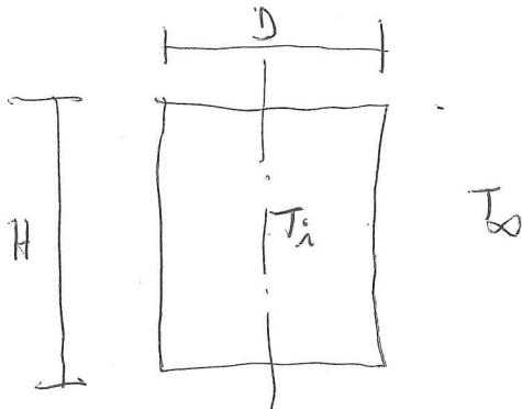
Simplificação:  $\left\{ \begin{array}{l} \text{só convecção do calor} \\ \text{condutividade} \propto D \end{array} \right. \Rightarrow \text{condutividade global}$
