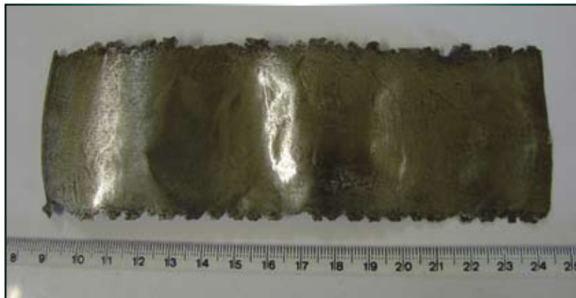
Fig. 3 – O aspecto extremamente irregular da folha é causado pelo alto grau de encruamento aplicado à mesma
