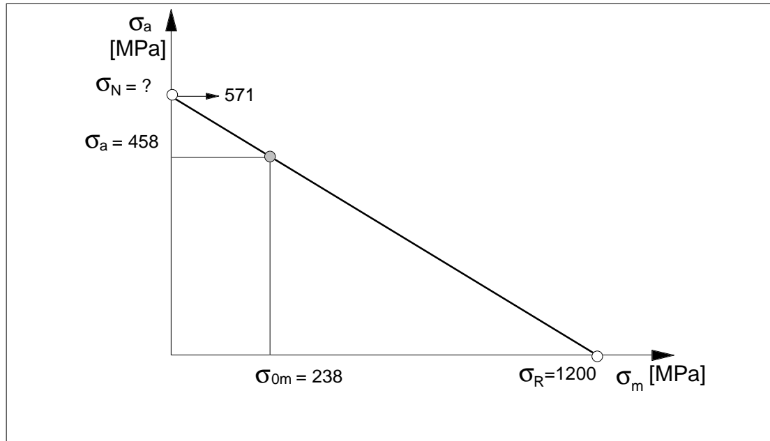
Figura 11.24 - Diagrama de Goodman para o exemplo 11.5.
