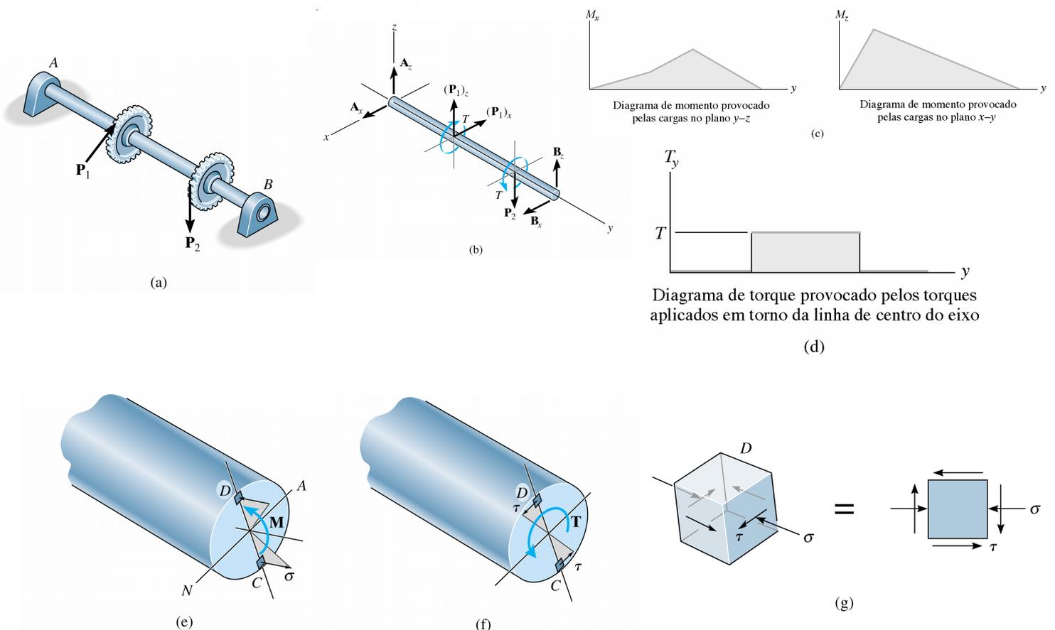
Os esforços considerados mais críticos no eixo são os momentos fletores e torques. O efeito da força constante habitualmente é desprezível. Devido disto que os pontos críticos numa seção qualquer são D e C (figura acima, itens (e) e (f)). Nesse ponto o estado plano de tensões é o indicado na figura acima, item (g), onde a tensão de flexão é:
