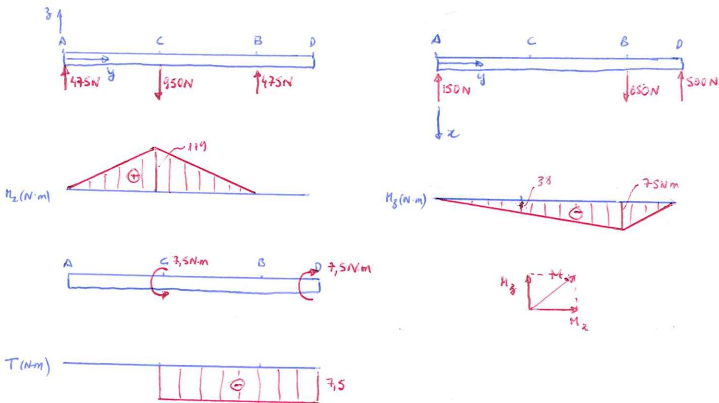
Por inspeção, a seção crítica, em onde  $\sqrt{M^2 + T^2}$  é máximo, ocorre em C:
