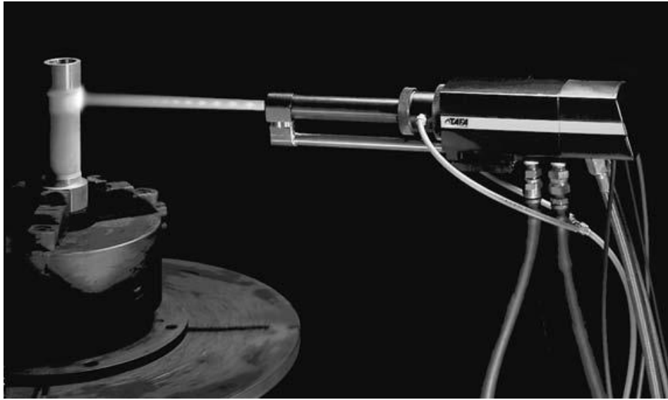
Figura 10 – Pistola do processo de AT por HVOF modelo JP – 5000 TAFSA.
