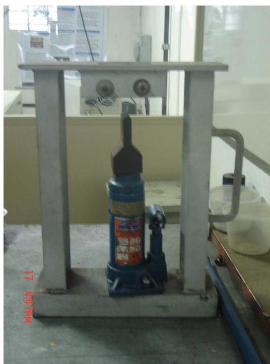
Figura 53. Equipamento de ensaio de dobramento (LABATS).
