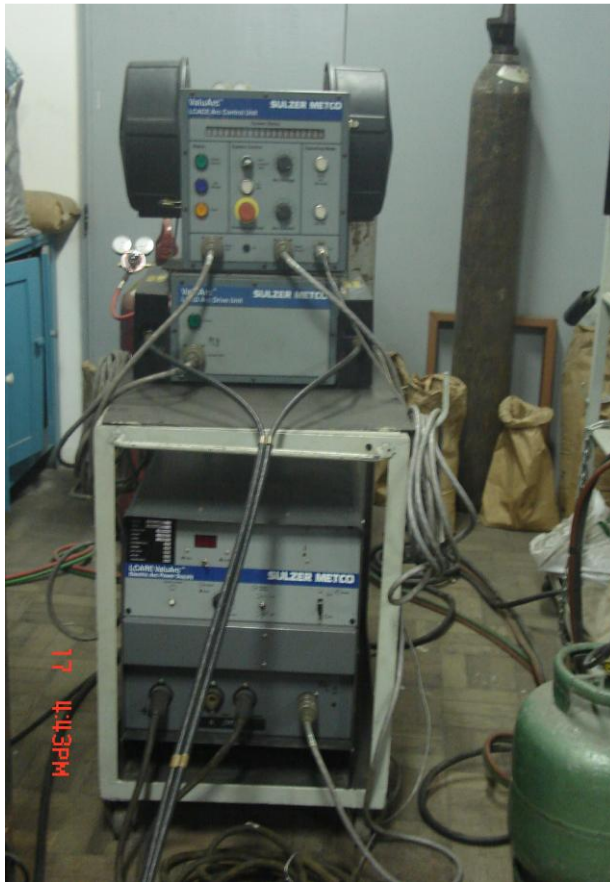
Figura 23. Equipamento de aspersão térmica por arco elétrico (LABATS).
