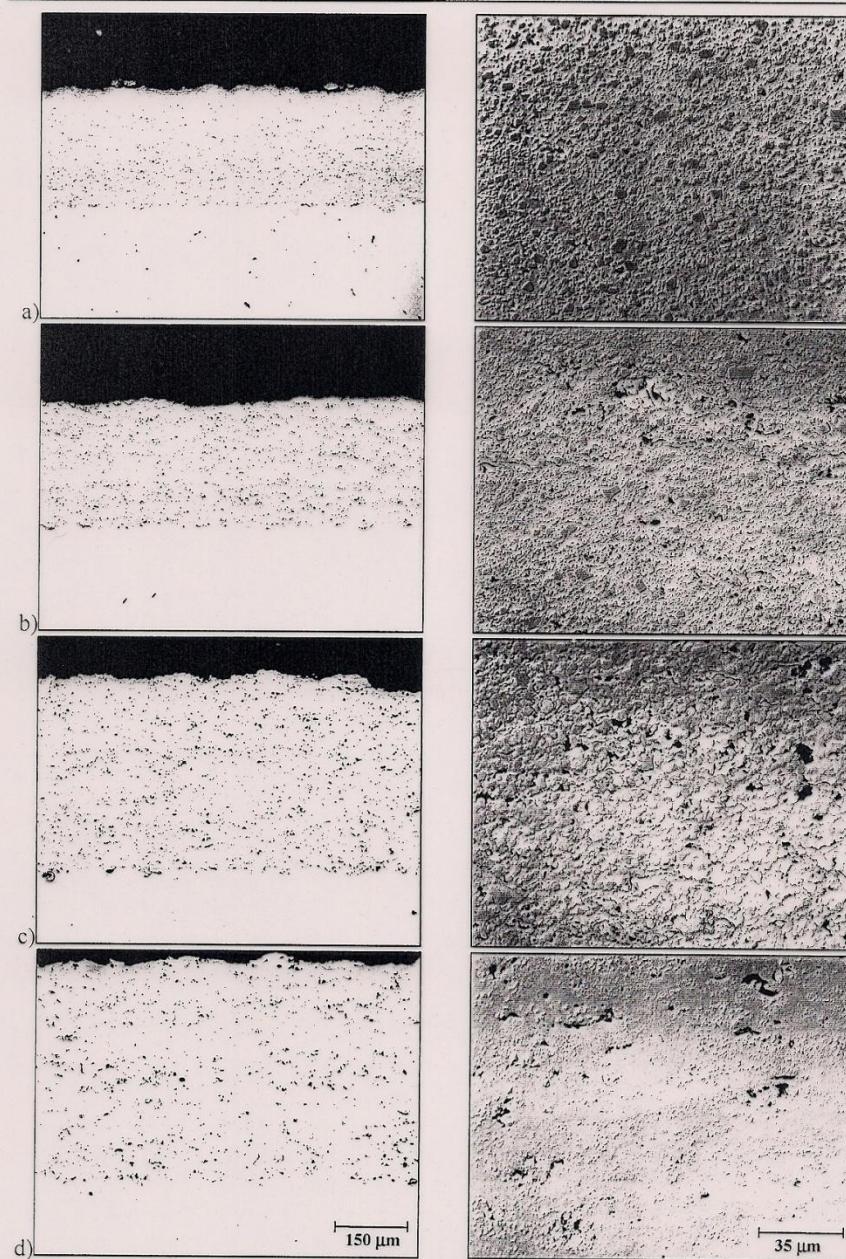
Figura 4.7 – Imagens do MO mostrando camadas, 200x e 1000x - pistola JP 5000
