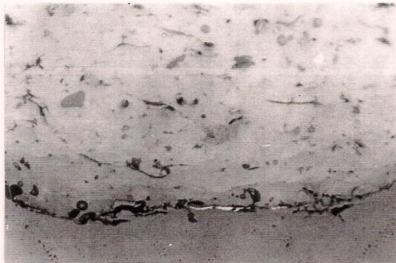
Bild 4a : Gefüge der \text{Al}_2\text{O}_3 -Schicht , kontrastiert (T4.1, Plasmaspritzen)
