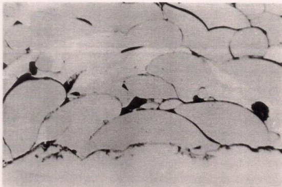
Bild 5a: Gefüge der NiCrBSi-Schicht (T5.2, konventionelles Flamspritzen) / FS pó
