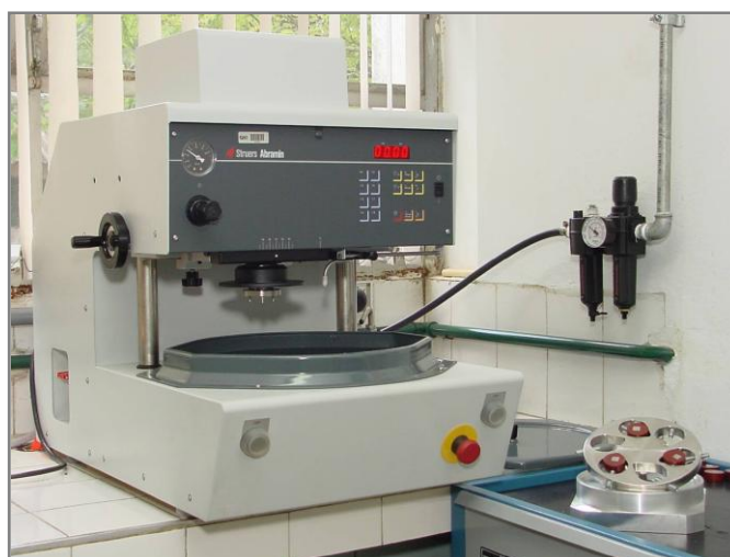
Figura 11. Politriz semi-automática Struers Abramin utilizada para os procedimentos de lixamento e polimento das amostras.
