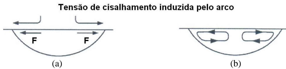
Figura 17: Direção das forças de convecção na poça de fusão, força tensão de cisalhamento induzida pelo jato de plasma.
