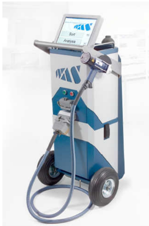
Figura 27: Equipamento para ensaio de análise química P.M.I FABRICANTE OXFORD PMI – MASTER PRO
