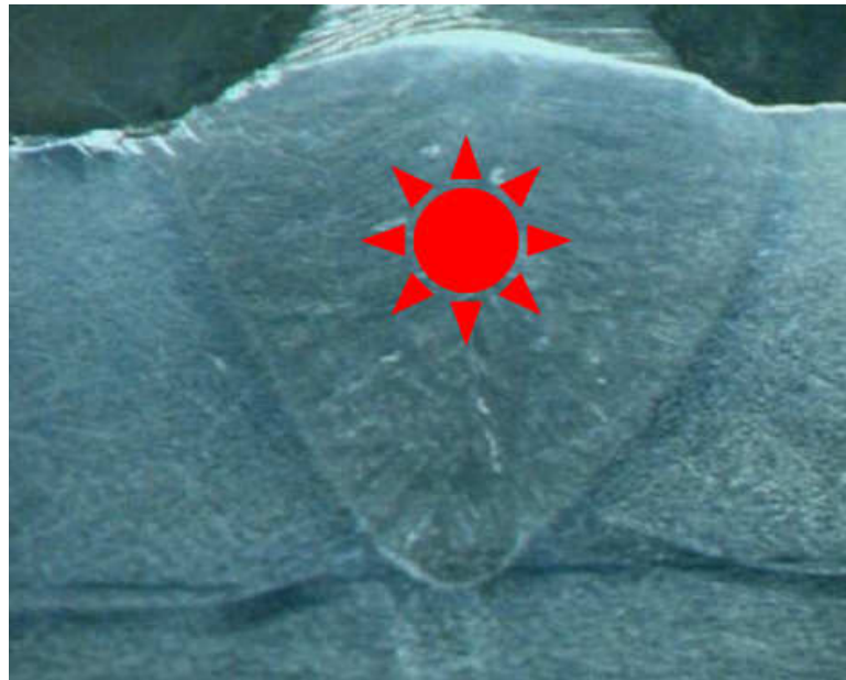
Figura 28: Esquema para medição da análise química no cordão de solda.
