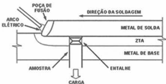
Figura 4 - Esboço esquemático do teste de implante para trinca de hidrogênio.
