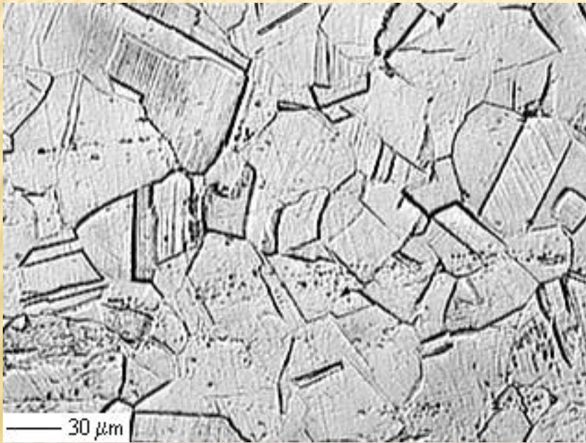
AISI 304 - Estrutura solubilizada “step”
