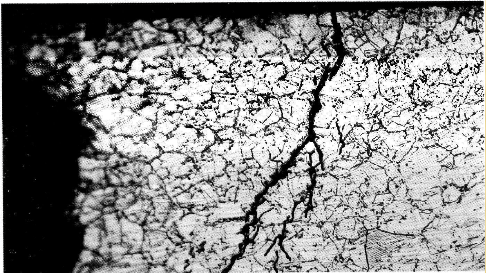
TRINCA DE CORROSÃO SOB TENSÃO INICIADA EM PONTO DE CORROSÃO INTERGRANULAR
