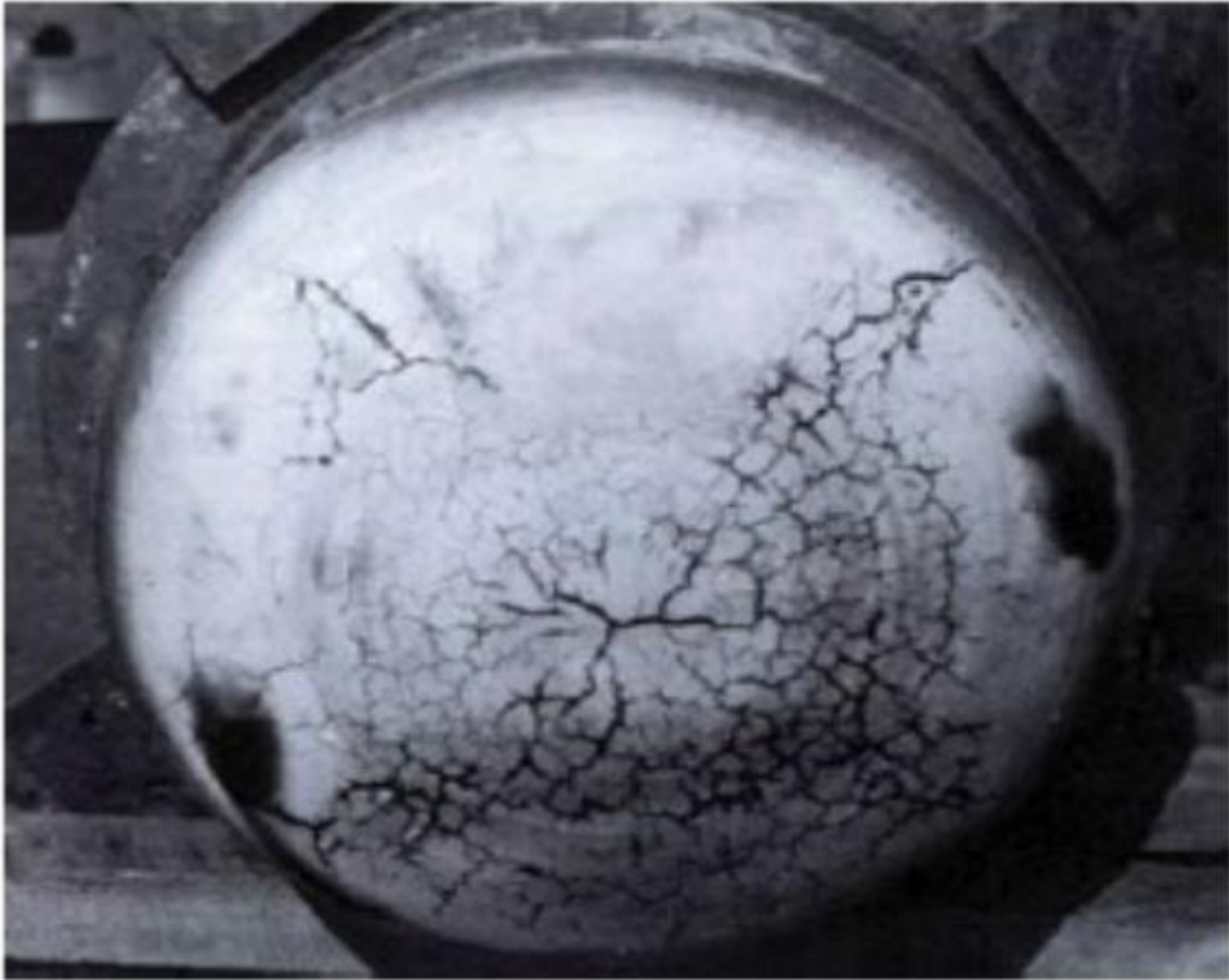
Fig. 10 - Corrosão sob tensão em uma autoclave de aço 304.
