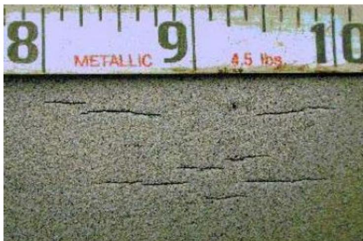
Figura 8: Exemplo de trincas de corrosão sob tensão.
