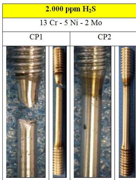
Figura 17: Ensaio com aço 13 Cr modificado com 2.000 ppm de H<sub>2</sub>S.
