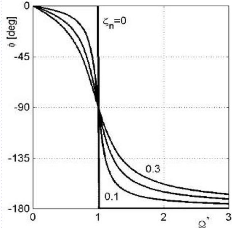
Resposta ao desbalanceamento de um Rotor de Jeffcott com amortecimento: amplitude adimensional ( $|rc_0/\varepsilon|$ ) e fase ( $\phi$ ) versus rotação adimensional ( $\Omega/\Omega_n$ )
