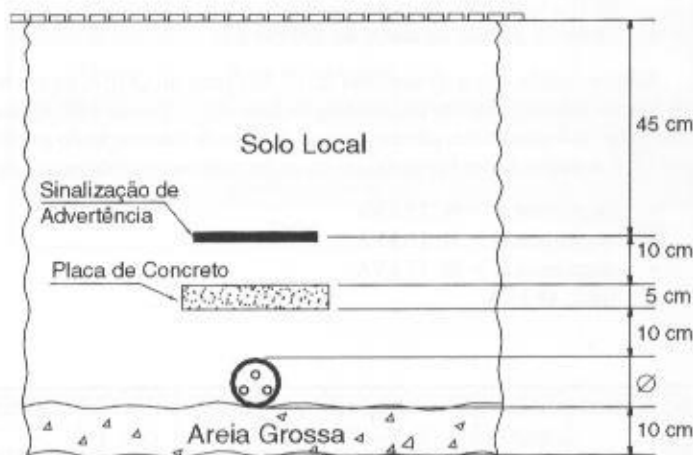
FIGURA 3.43 Cabos multipolares enterrados
