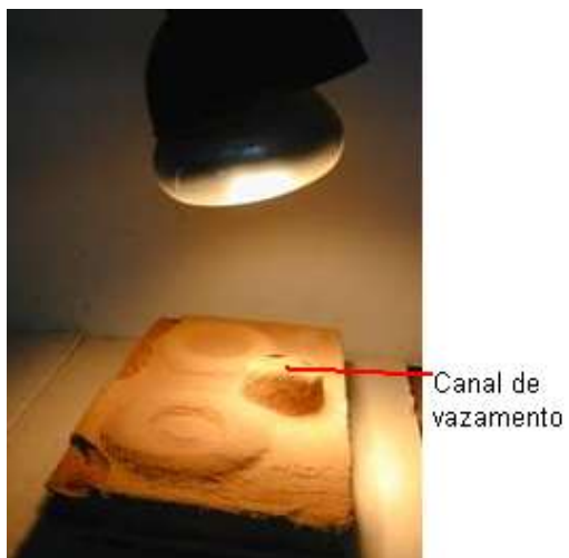
(Casca sendo unida e pré-aquecida)(Vazamento do molde com alumínio)
