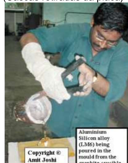
(Casca sendo unida e pré-aquecida)(Vazamento do molde com alumínio)
