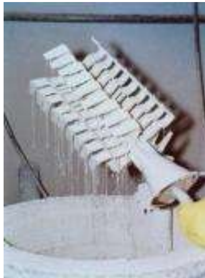
Figura 8 – Banho de lama refratária
