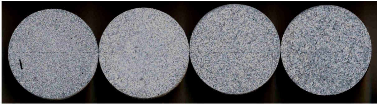
Figura 13. Macroestruturas da Liga Al-7%Mg: (A) Sem Pressão, (B) 40 MPa, (C) 80 MPa e (D) 120 MPa. Redução em 25% do tamanho original.
