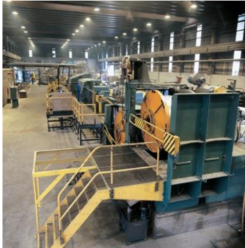
Produção de bobinas de Vergalhões Properzi
