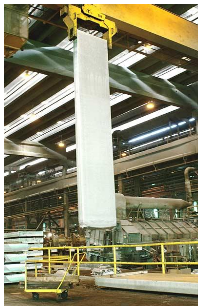
Transporte da placa após fundição
