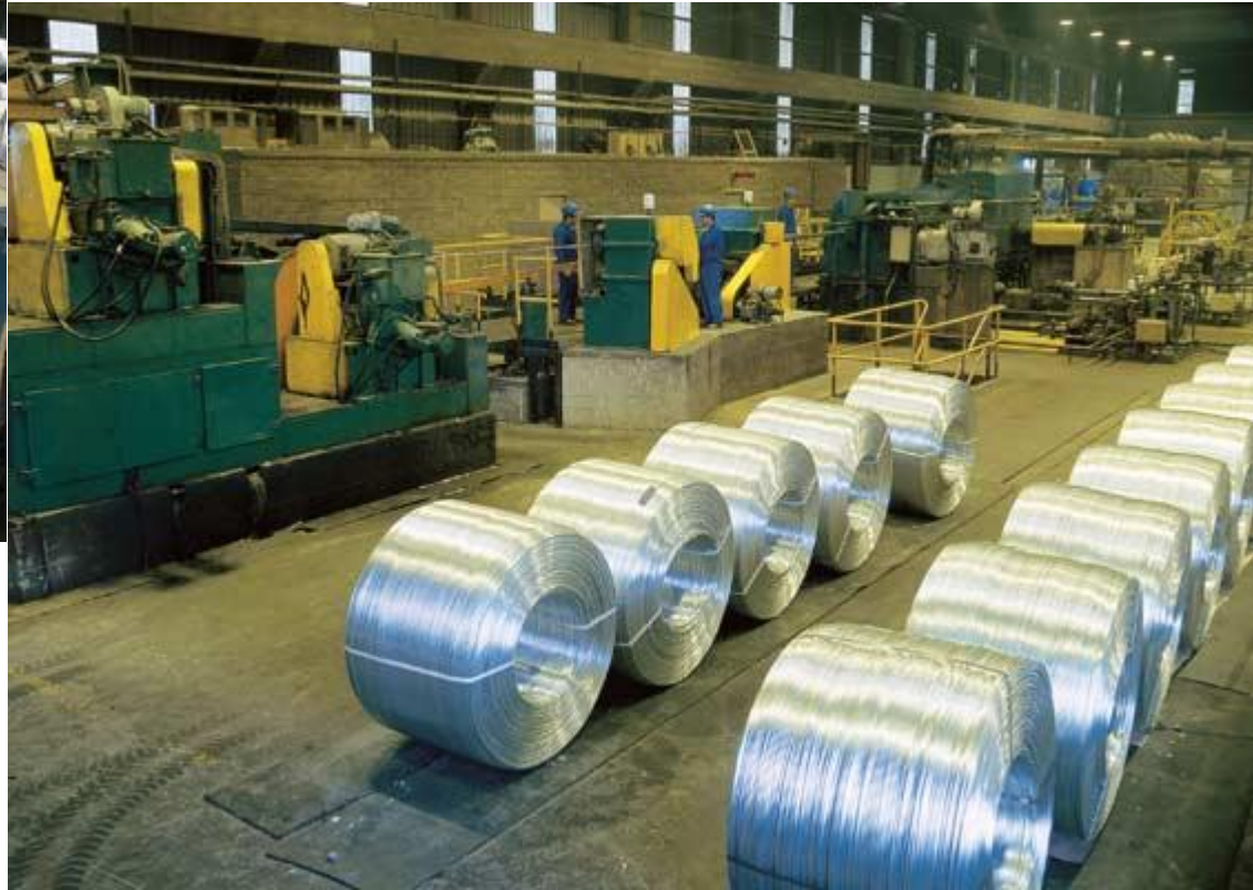
Produção de bobinas de Vergalhões Properzi
