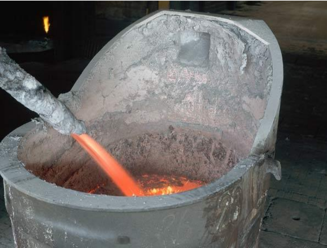
Alumínio líquido retirado das cubas eletrolíticas
