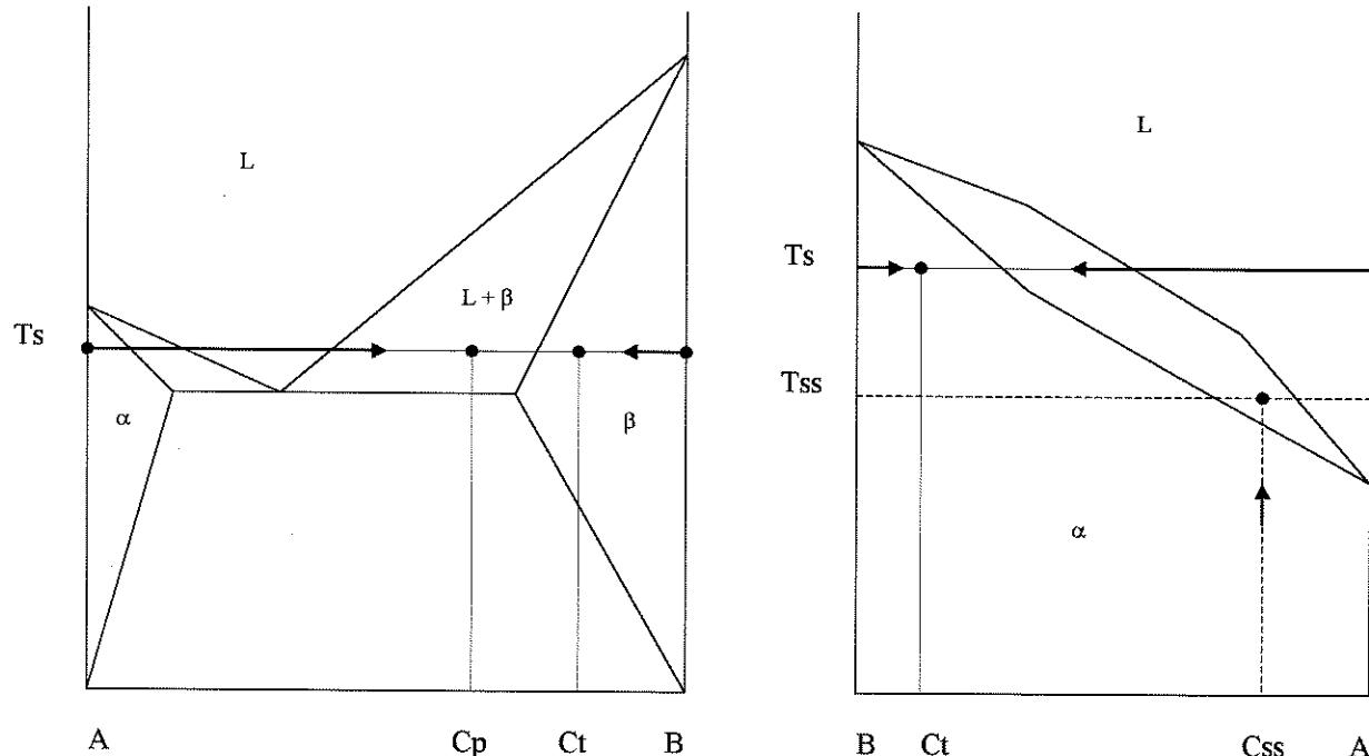
**S. F. L. permanente (Cp) e transiente (Ct) em uma mistura binária de pós, e sinterização supersólida (Css) em um pó pré-ligado; C = concentrações de equilíbrio, Ts e Tss = temperaturas de sinterização.**
