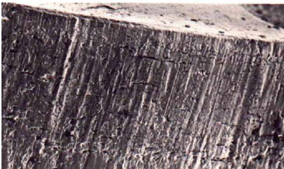
Fig.6: MEV da superfície desgastada por desgaste adesivo de uma ferramenta confeccionada em aço AISI D2 temperado para 46 HRC. Material estampado: inoxidável austenítico
