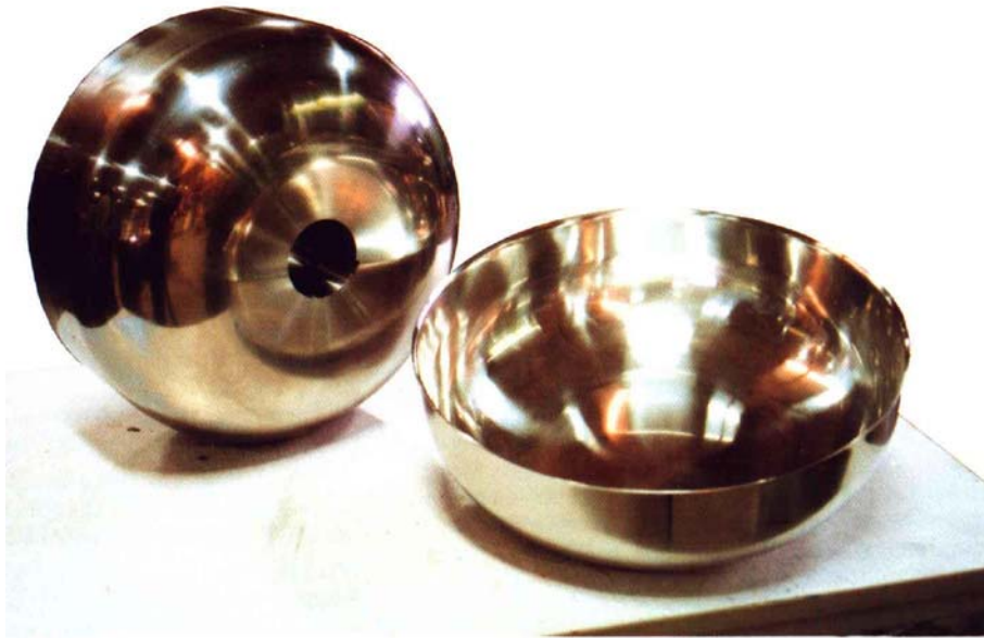
Fig. 9: Exemplo de produção por estampagem profunda em aço inoxidável . Produto com elevado grau de requisitos estéticos. Punção em AISI D2
