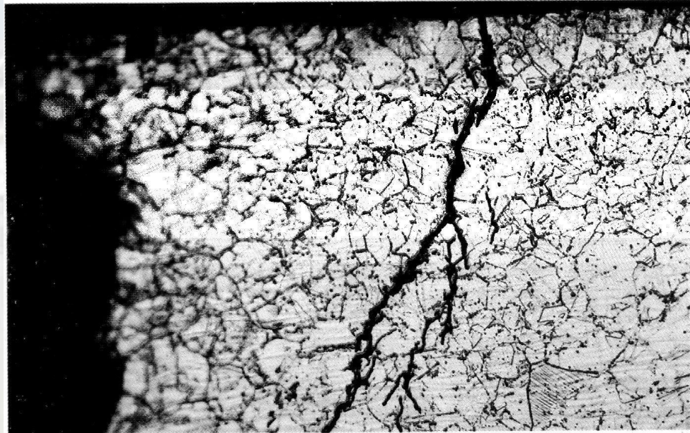
TRINCA DE CORROSÃO SOB TENSÃO INICIADA EM PONTO DE CORROSÃO INTERGRANULAR
