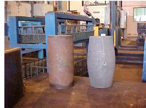
Efeito da expansão volumétrica em corpos de prova de 60 kgs (aço carbono). Peças tiradas da mesma barra original.
