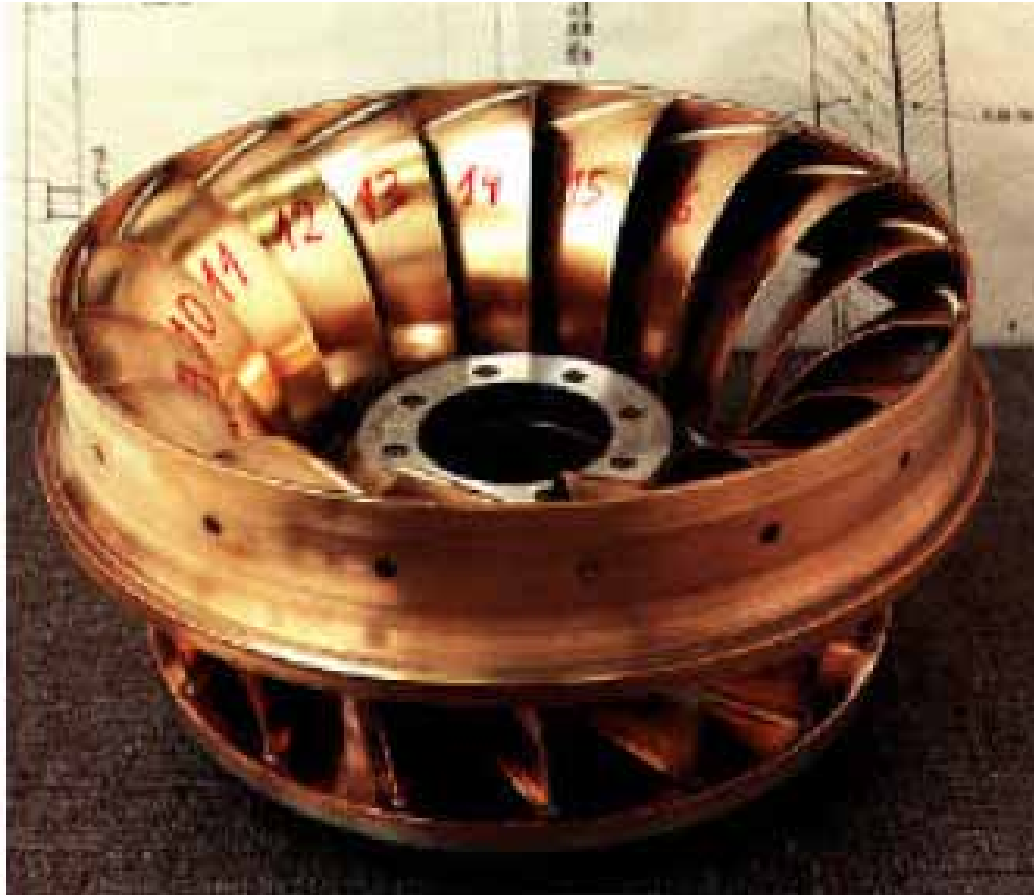
Rotor de uma turbina Francis
