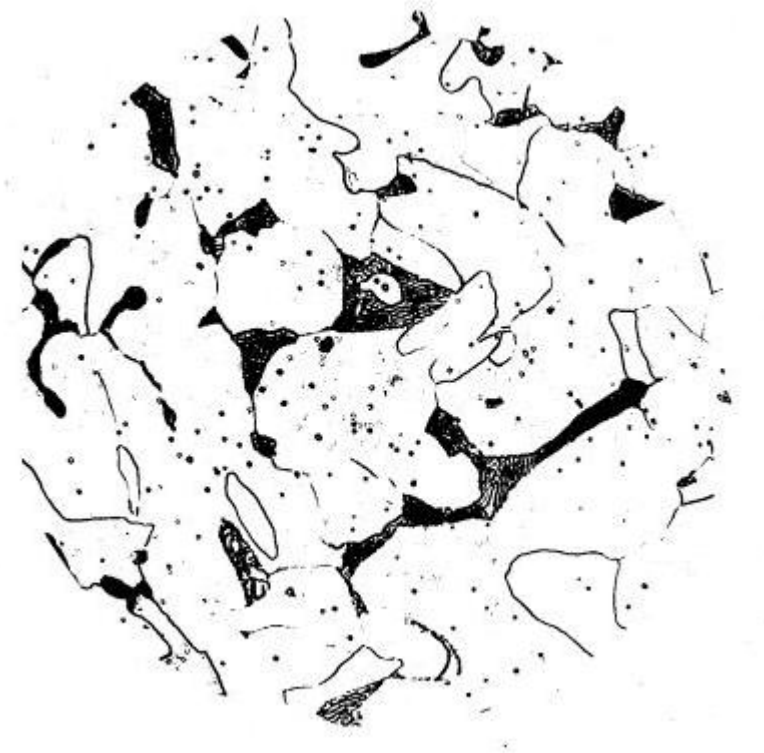
Figura 2 – Aço baixo-carbono (Composição química: 0,13 % C - 0,22% Si - 0,42% Mn - < 0,04% S - < 0,04% P), apresentando microestrutura de grãos grosseiros de ferrita e perlita. Aumento 500x (Microscópio Ótico).
