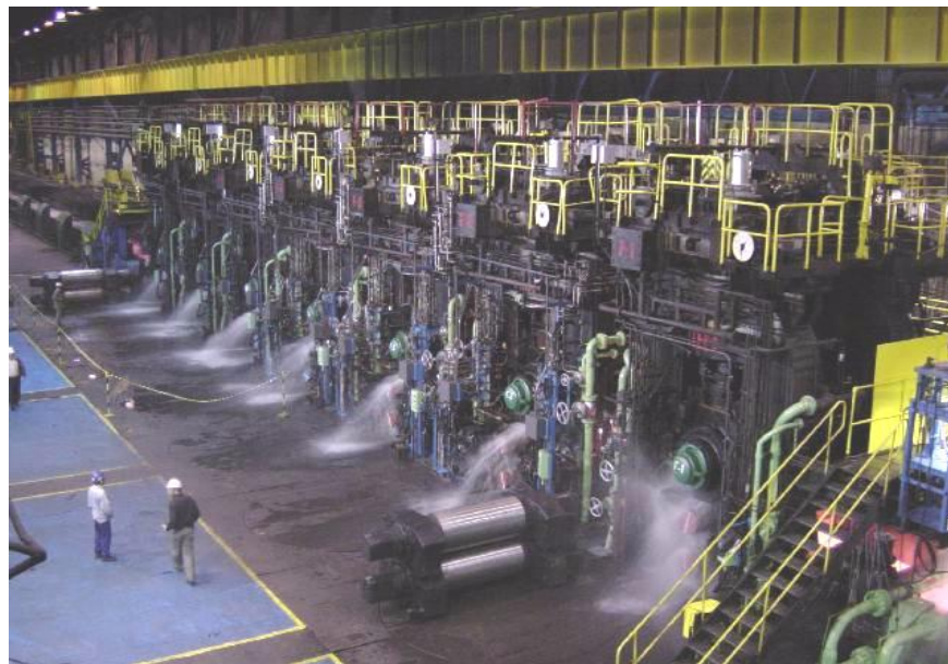
Figura 2.22 - Laminador de Acabamento com sete cadeiras.
