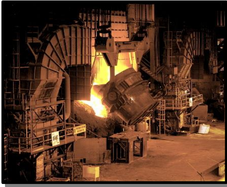
Figura 2.9 – Fotografia mostrando o carregamento de Ferro gusa no Conversor a Oxigênio.
