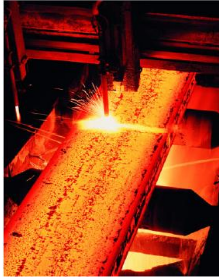
Figura 2.18 – Fotografia da placa sendo cortada.
