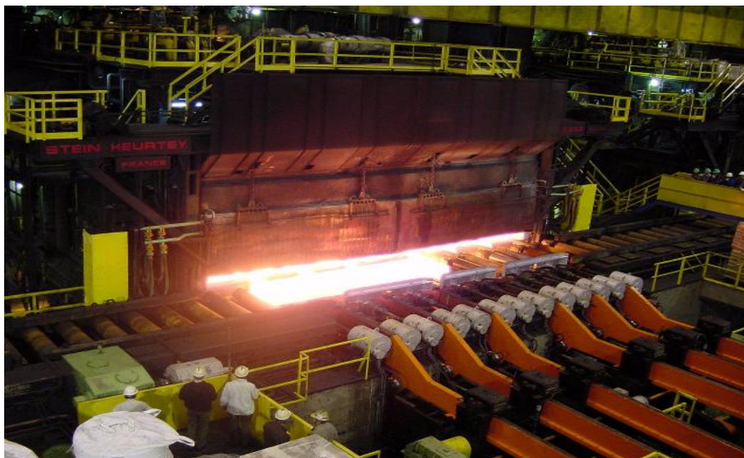
Figura 2.20 - Placa ao final do reaquecimento entrando no leito do Laminador de Tiras à Quente.
