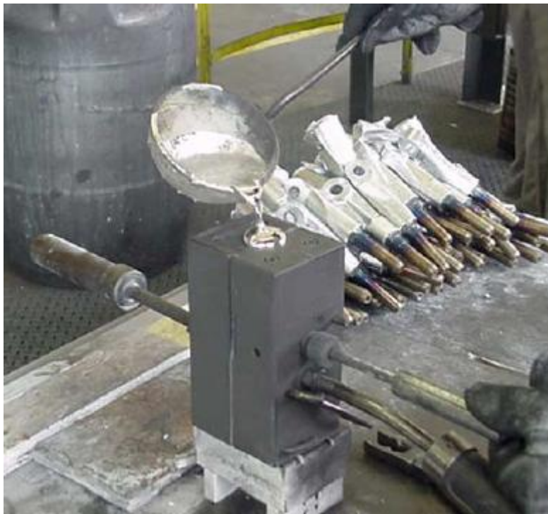
Figura 6.21 – Aços Ferramenta para moldes de fundição de Alumínio (Coquilha fechada durante vazamento).
