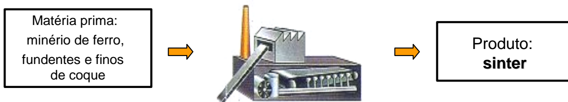
Figura 2.4 – Esquema da sinterização.
