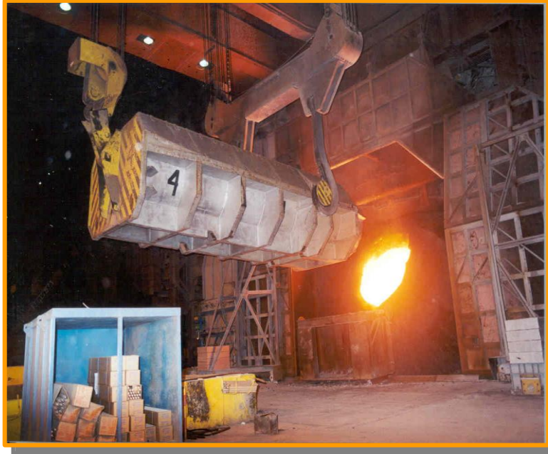
Figura 2.10 – Fotografia mostrando o carregamento de sucata no conversor.
