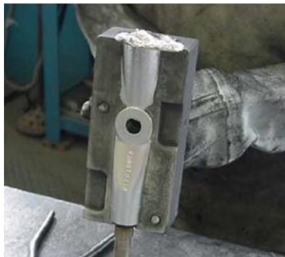
Figura 6.22 – Aços Ferramenta para moldes de fundição de Alumínio (coquilha aberta).
