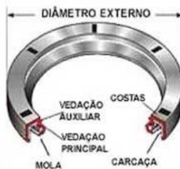
Figura 88 - Vedação do retentor.
