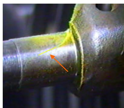
Indicação típica de trinca num eixo automotivo, obtido pela técnica de magnetização por contato direto , método via seca com partículas visíveis com luz branca.
