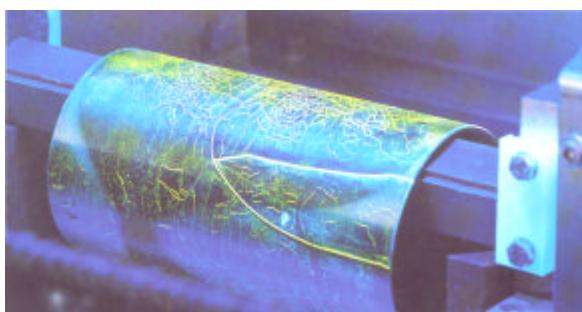
Inspeção por partículas magnéticas fluorescentes de um anel contendo inúmeras trincas.
