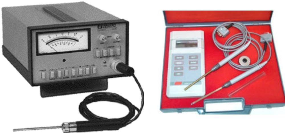
Medidor típico de campo magnético utilizando a sonda de Hall. Pode medir de 10 até 30.000 Gauss , muito útil para verificação do valor do campo magnético efetivo na peça a ser inspecionada por partículas magnéticas ou ainda campos residuais.
