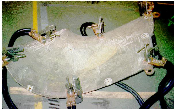
Ensaio de uma peça pela técnica de magnetização multidirecional.
