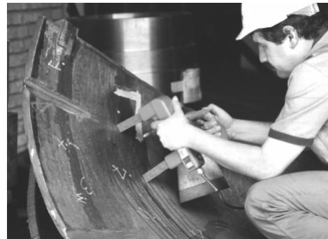
Inspecção por Partículas Magnéticas pela Técnica do Yoke , de um chanfro preparado para soldagem, em uma Pá tipo “Francis” fundida em aço carbono, para usina hidroelétrica.
