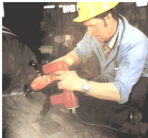
Técnica de inspeção de fundidos usando Yoke com pernas articuláveis
