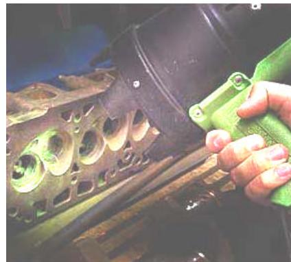
Equipamento para iluminação por luz ultra-violeta ( luz negra) para uso com partículas magnéticas fluorescentes. De acordo com a norma aplicável o nível mínimo da intensidade de luz na superfície deve ser de  $1000 \mu\text{W}/\text{cm}^2$ , medido com instrumento calibrado e adequado a este tipo de luz.
