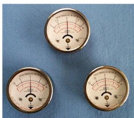
Instrumentos de medição/ indicação de campo magnético residual denominado Gaussímetro. Quando colocado sobre a superfície do material inspecionado, o instrumento deve indicar , com pouca precisão , o campo magnético residual
