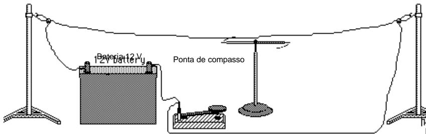
Diagrama esquemático da experiência de Oersted<sup>2</sup> comprovando que a passagem da corrente elétrica pelo fio condutor fez oscilar uma agulha de compasso devido à presença do campo magnético produzido pela corrente elétrica.
