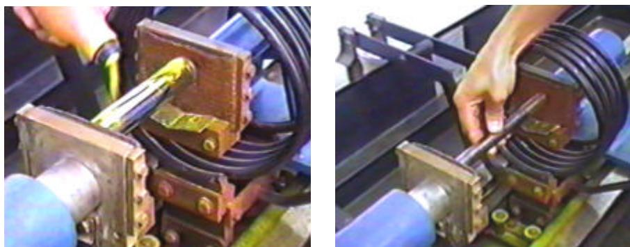
Fotos mostrando a técnica de magnetização circular por contato direto. Na foto esquerda o técnico pulveriza o pó magnético seco num eixo magnetizado por passagem de corrente elétrica. Na foto direita o técnico posiciona uma barra para a técnica de contato direto.
