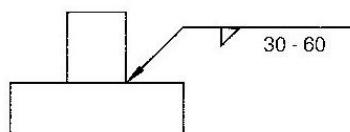
O espaçamento de uma solda descontínua também é indicado à direita do símbolo; no caso de solda descontínua coincidente, o símbolo é colocado acima e abaixo da linha de referência. A dimensão do espaçamento de uma solda descontínua intercalada também é indicada à direita do símbolo, seguida pela dimensão do comprimento.
