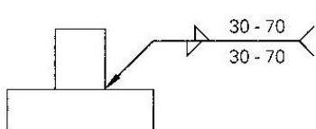
*se o comprimento da solda é total ou contínuo, não é necessário cotar; porém, se a solda é descontínua, a cotagem é obrigatória*
