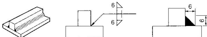
No caso de solda de pernas desiguais, as cotas devem indicar primeiro a altura da perna e depois o comprimento dela.
