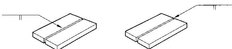
A linha de seta pode ser contínua ou quebrada, esta também chamada ziguezague. A linha de seta contínua indica que qualquer um dos lados da junta pode apresentar chanfro. A linha de seta quebrada ou ziguezague indica o lado da junta que deverá ser chanfrado.
