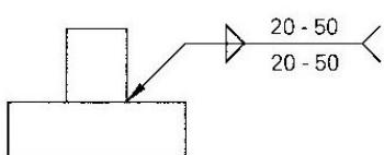
Os símbolos típicos indicam os procedimentos mais usuais de soldagem e trazem indicações, colocadas nos símbolos básicos, que são relacionadas a detalhes do processo, tais como abertura de ângulo, dimensões de solda, de espaçamento entre centros de incrementos, altura do depósito e outras.
