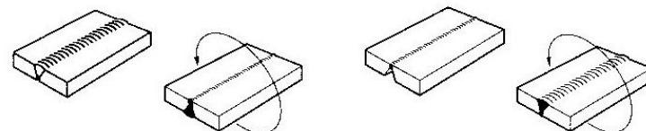
O símbolo da solda de encaixe para junta brasada é representado por duas linhas retas inclinadas, colocadas acima, abaixo ou em ambos os lados da linha de referência. Indica um chanfro inclinado na junta.
