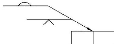
O símbolo de solda no campo é representado por um triângulo cheio, ligado a um traço vertical e indica que a junta deve ser soldada no final da montagem do conjunto; isto acontece no caso de soldagem de conjuntos formados por peças muito grandes que só podem ser montadas na obra; a ponta do triângulo ou bandeira deve estar sempre em posição oposta à da linha de seta.
