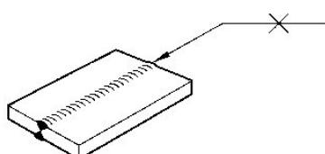
A linha de seta parte de uma das extremidades da linha de referência e indica a região a ser soldada; o local exato da soldagem é especificado pelo posicionamento do símbolo, acima ou abaixo da linha de referência. A linha de seta pode ser colocada tanto na extremidade esquerda quanto na direita da linha de referência; cabe ao desenhista do projeto decidir a localização adequada, de acordo com o espaço e a estética do desenho.
