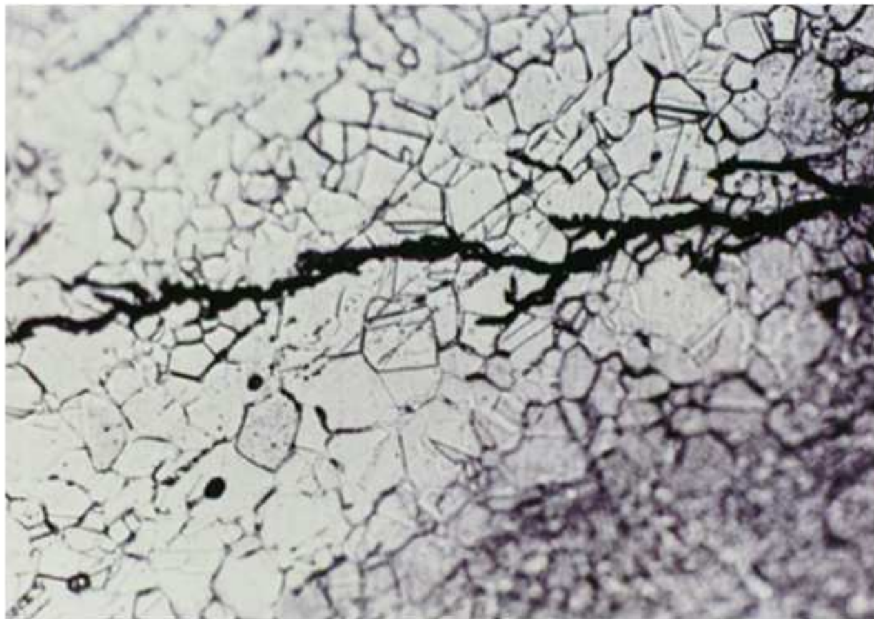
Trincas transgranulares, no tubo fraturado, verificadas na análise metalográfica.
