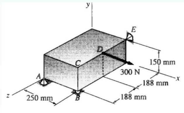
Uma caixa retangular tem juntas esféricas em  $A$  e  $E$  e um rolete apoiado na superfície horizontal em  $B$ . Determine a reação em  $B$  quando uma força horizontal de  $300\text{ N}$  é aplicada ao ponto médio  $D$  de  $CE$ .
