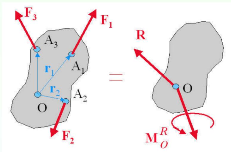
Se a resultante  $\mathbf{R}$  e o vetor  $\mathbf{M}_O$  forem perpendiculares entre si, o sistema força-binário em  $O$  pode também ser reduzido a uma única força resultante.
