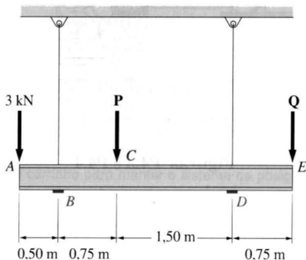
Duas hastes  $AB$  e  $DE$  estão ligadas por um perfil. Sabendo que a tração na haste  $AB$  é de  $750\text{ N}$  determine: (a) a tração na haste  $DE$  e (b) a reação em  $C$ .
