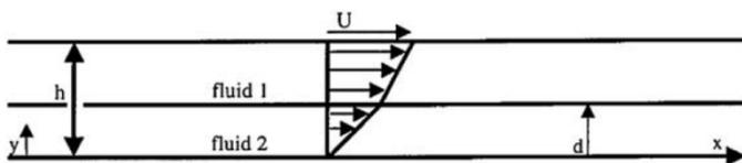
dois fluidos viscosos imiscíveis e de viscosidade diferente são colocados entre as placas. Encontre a distribuição de velocidades em cada um dos fluidos.
