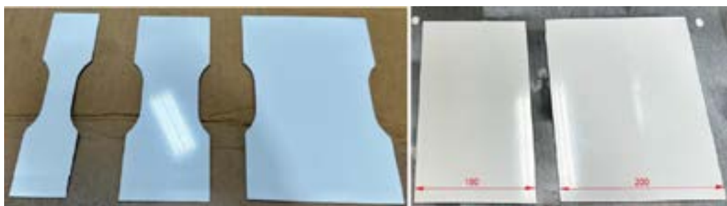
Figura 3: Geometria dos corpos de prova Nakajima.
