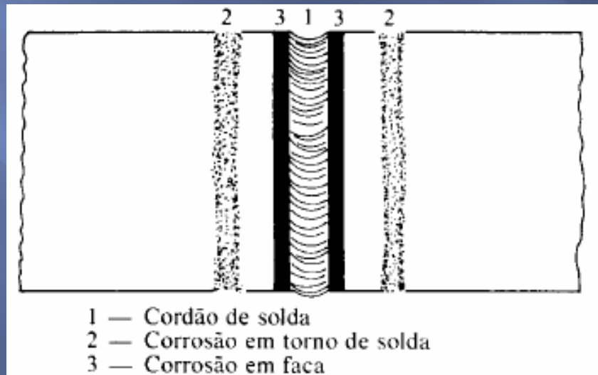
Diferentes áreas de corrosão em torno da solda
