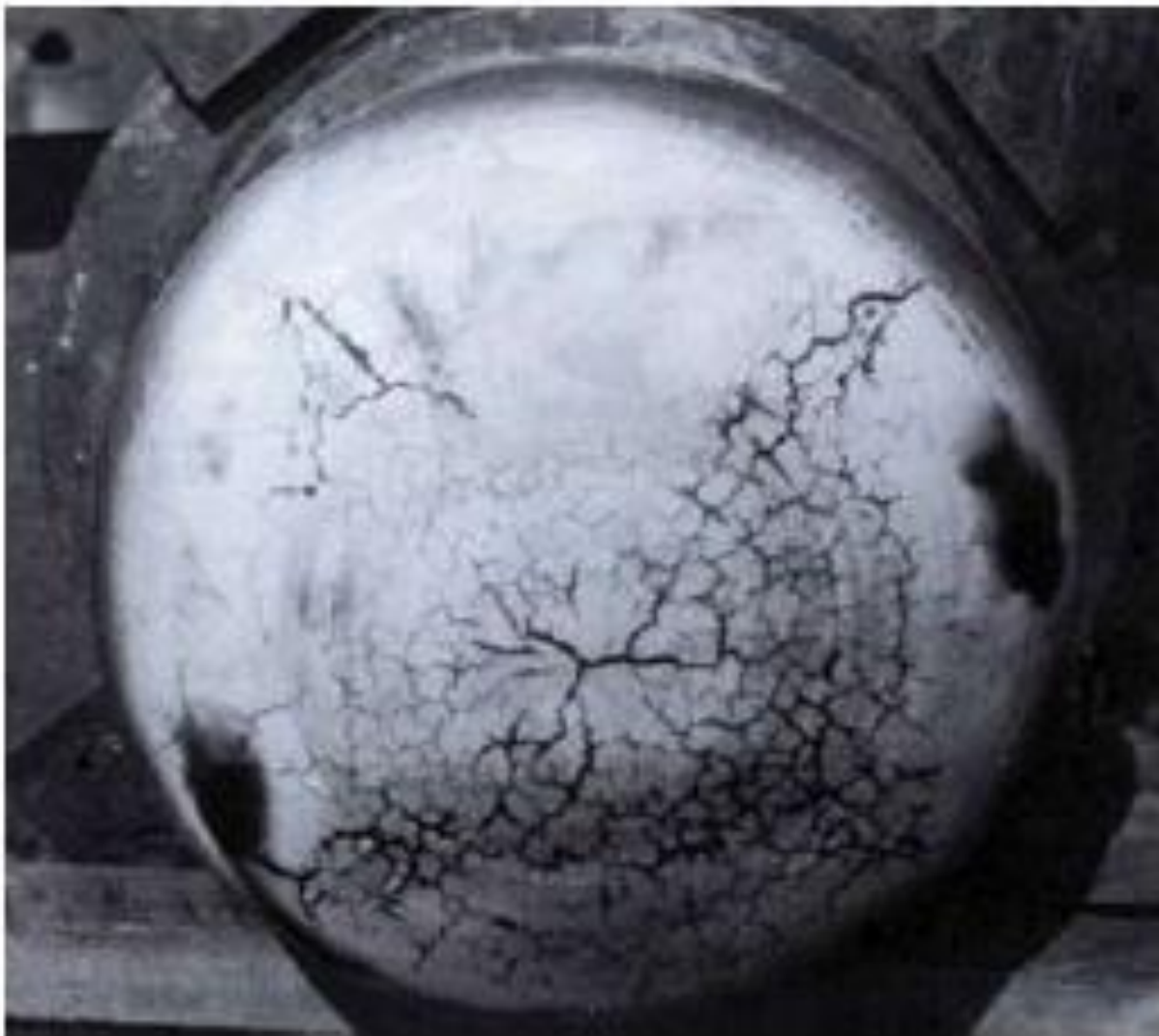
Fig. 10 - Corrosão sob tensão em uma autoclave de aço 304.
