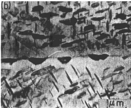
TEM de ZLP em Al3%Cu, 300 oC / 16 min Hornbogen & Kreye
